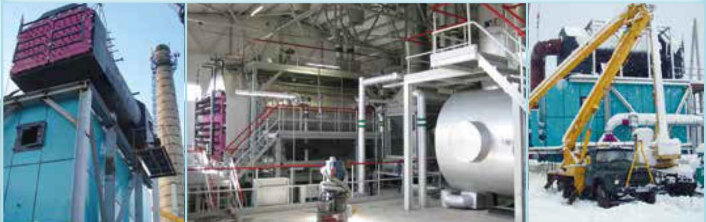
Zasićena para  $190^{\circ} \text{C}$ , 12 bara, odvajanje procesne pare 18t/h • Ložište: hidraulična pomična rešetka
