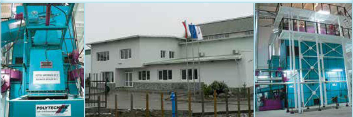
Vruća voda ( $110^{\circ} \text{C}$ ) • Ložište: hidraulična pomična rešetka • Gorivo: drvna sječka, kora • Pušteno u pogon: 2007
