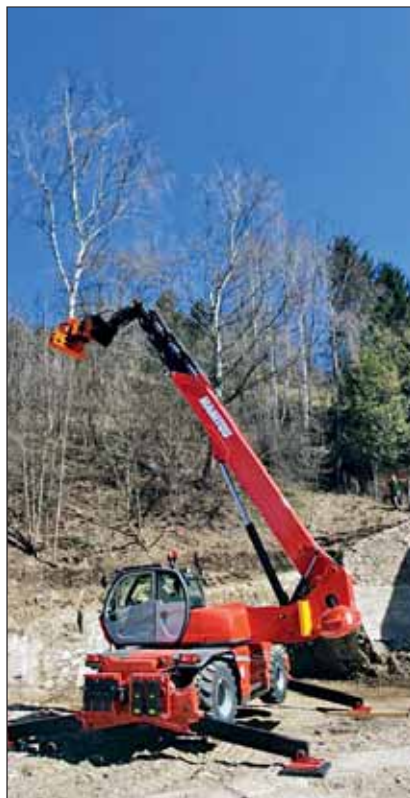
Die Maschinenkombination bietet bis zu 30 m Reichweite und einen sicheren Griff des abgetrennten Baumteils.
